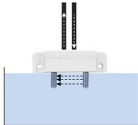
При замыкании контактов жидкостью срабатывает сигнал тревоги
